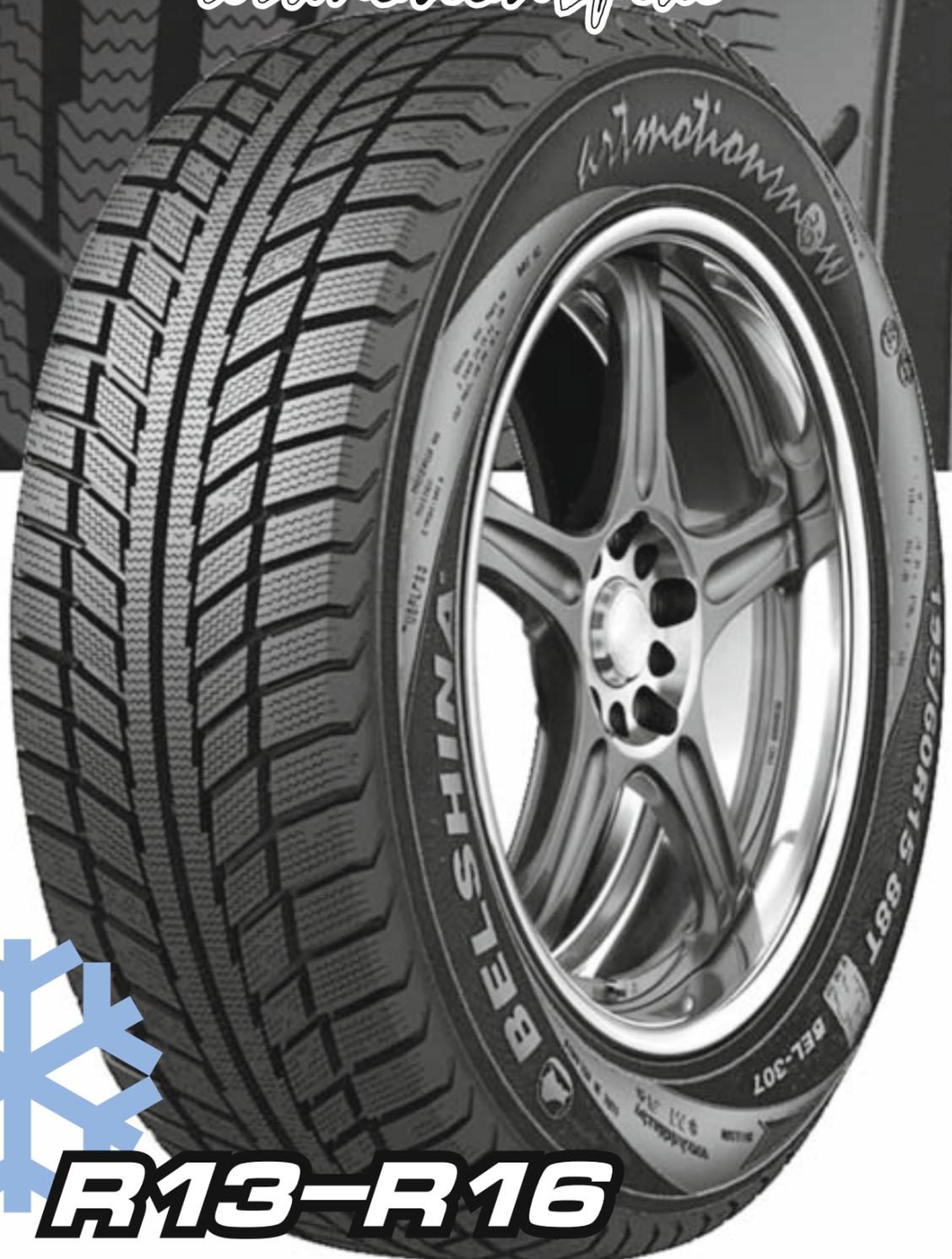
Новая линейка легковых радиальных бескамерных шин R13–R16 «artmotionsnow» и «artmotionspike», с металлокордом в брекере, с зимним направленным рисунком протектора, предназначена для эксплуатации на легковых автомобилях зарубежного производства на дорогах различных категорий в заснеженном и обледенелом состоянии.
