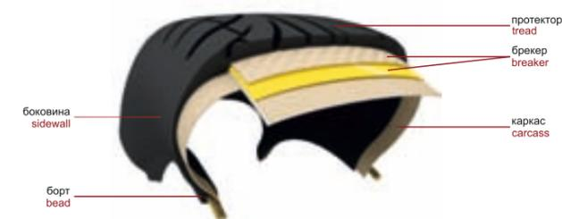
**По типу конструкции** различают диагональные и радиальные шины.
