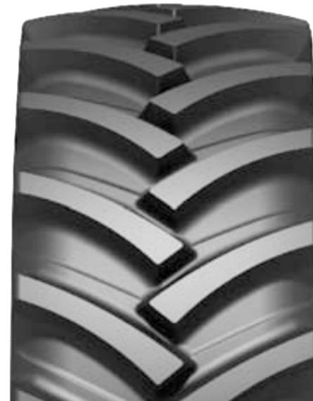
Рисунок протектора выполнен в соответствии с учётом специфики применения данной шины на трактора большой мощности и обеспечивает движение сельхозмашины как по грунтам, так и по дорогам с твёрдым покрытием.
